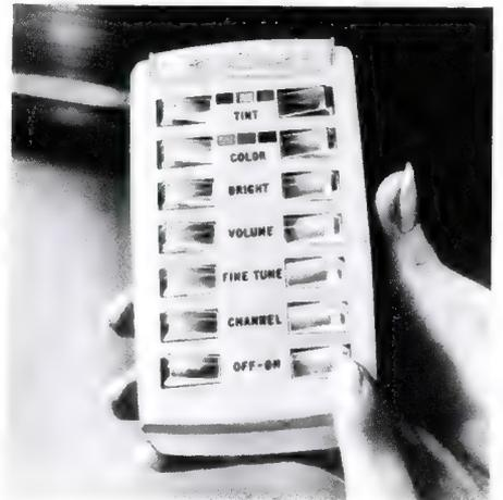
Fernsteuergerät für Farbfernsehempfänger mit transistorisiertem Ultraschallsender
