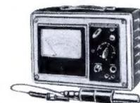
Kleinster Meßbereich 1 Volt, dabei Eingangswiderstand 10 M $\Omega$ , Wechselspannungen m. Tastkopf im Bereich von 30 Hz - 230 MHz bis 15 Volt. Einschließl. Hochspannungstastkopf u. Aufsteckteiler **420.-**
